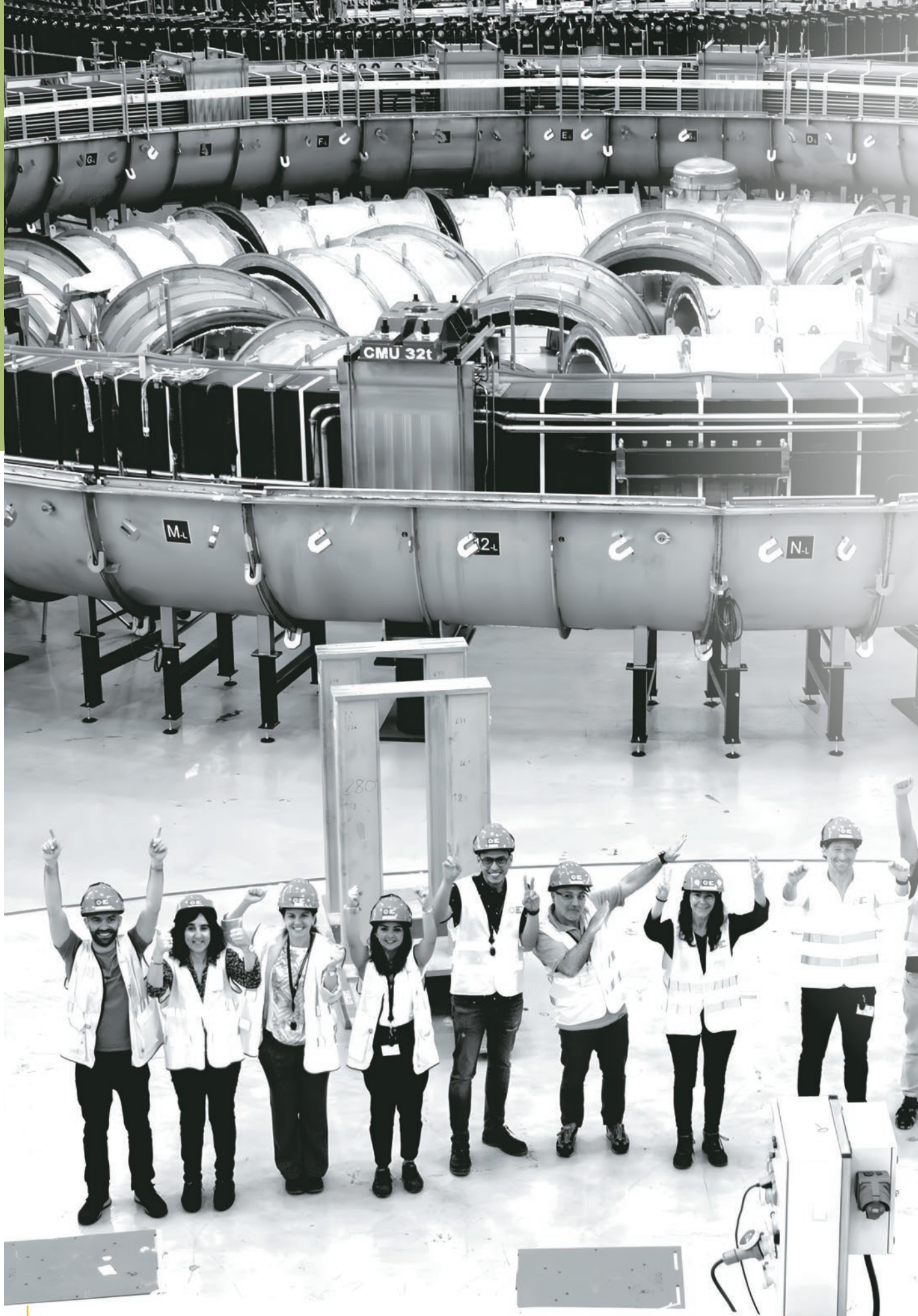
Cette bobine annulaire de 350 tonnes (n°4) vient de passer des « essais à froid » avec succès. Au mois d'août, elle quittera l'atelier de fabrication pour un lieu de stockage sur le site ITER.
